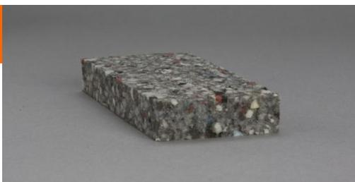
Aggloform's est composé de déchets de mousse de Polyuréthane agglomérés au moyen d'un liant.
