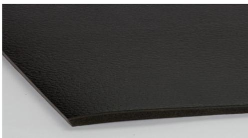
Le Isole son est un isolant phonique et un amortisseur de vibrations composé d'une couche supérieure en PVC compact, avec dessin cuir, d'une couche centrale barrière antibruit d'une masse de 4 kg/m<sup>2</sup> et d'une couche inférieure anti-vibratile en mousse PVC. Le Isole son présente une masse de 6 kg/m<sup>2</sup>.
