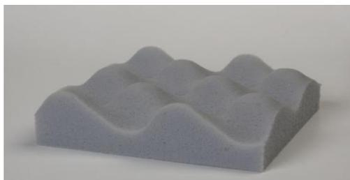
La Mousse à Picots M1 est composée de mousse de mélamine d'une densité de 11Kg/m<sup>3</sup>. Il s'agit d'une mousse à cellules ouvertes, dont la particularité est de présenter une très bonne souplesse ainsi qu'une très bonne absorption des bruits aériens.
